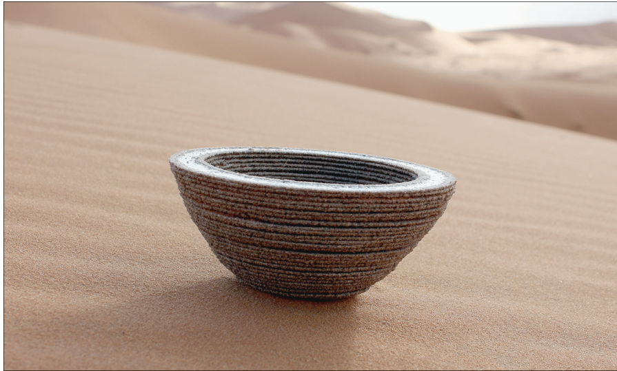
Abbildung 1.6: Eine Naturglas-Schale, geformt mithilfe von Sonnenlicht, mit dem der Solar Sinter Sand einschmilzt (Bild mit freundlicher Genehmigung von Markus Kayser)
