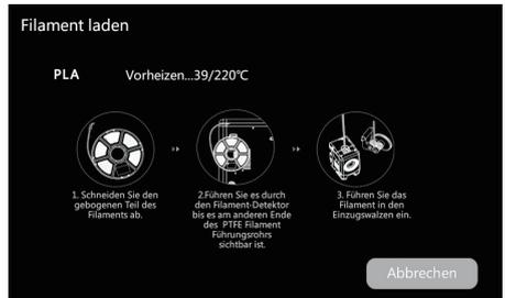
C3. Die Zuführung beginnt nach dem Aufheizen. Erfolgreiches Extrudieren des Filaments aus der Düse zeigt ein erfolgreiches Laden an. Kontrollieren Sie abschließend ob das Filamentführungsrohr ordnungsgemäß eingesetzt ist.
