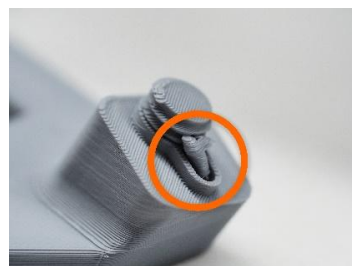
图 3 支架连接处的悬垂物
